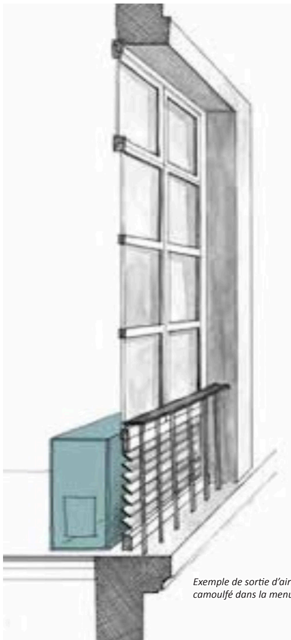
Exemple de sortie d'air conditionné camouflé dans la modénature
